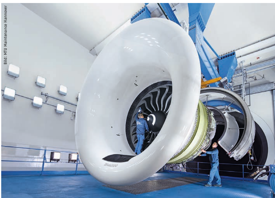
Ein GE90-Triebwerk, derzeit das größte der Welt, wird auf einen Prüflauf vorbereitet.
